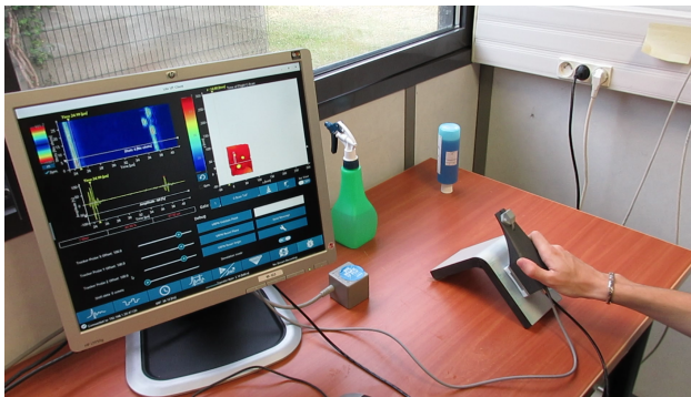
FIGURE 5.11 – Prototype de simulateur opérationnel en CND appliqué à l'inspection de pièce en matériau composite avec des TFP
