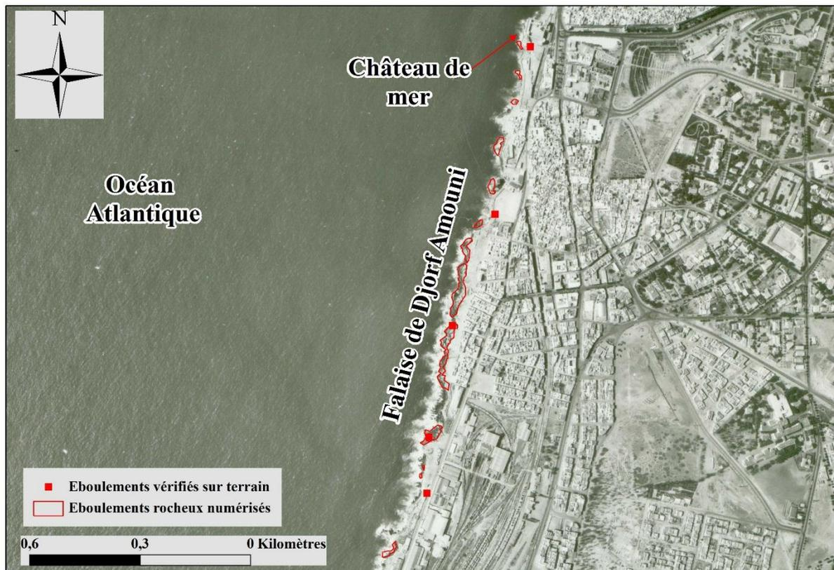
Figure 4.44 – Extrait de l’inventaire des éboulements rocheux représentés sur la photo aérienne de Safi au 17500<sup>ème</sup> datées de 1983
