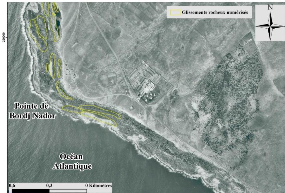
Figure 4.49 – Extrait de l’inventaire des glissements rocheux numérisés à partir de la photo aérienne de Safi au 17500<sup>ème</sup> datées de 1983
