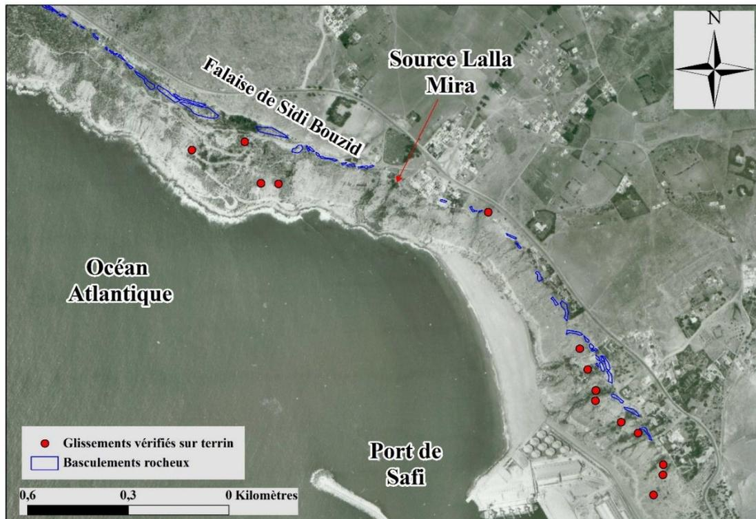
Figure 4.47 – Extrait de l'inventaire des basculements rocheux numérisés à partir de la photo aérienne de Safi au 17500<sup>ème</sup> datées de 1983
