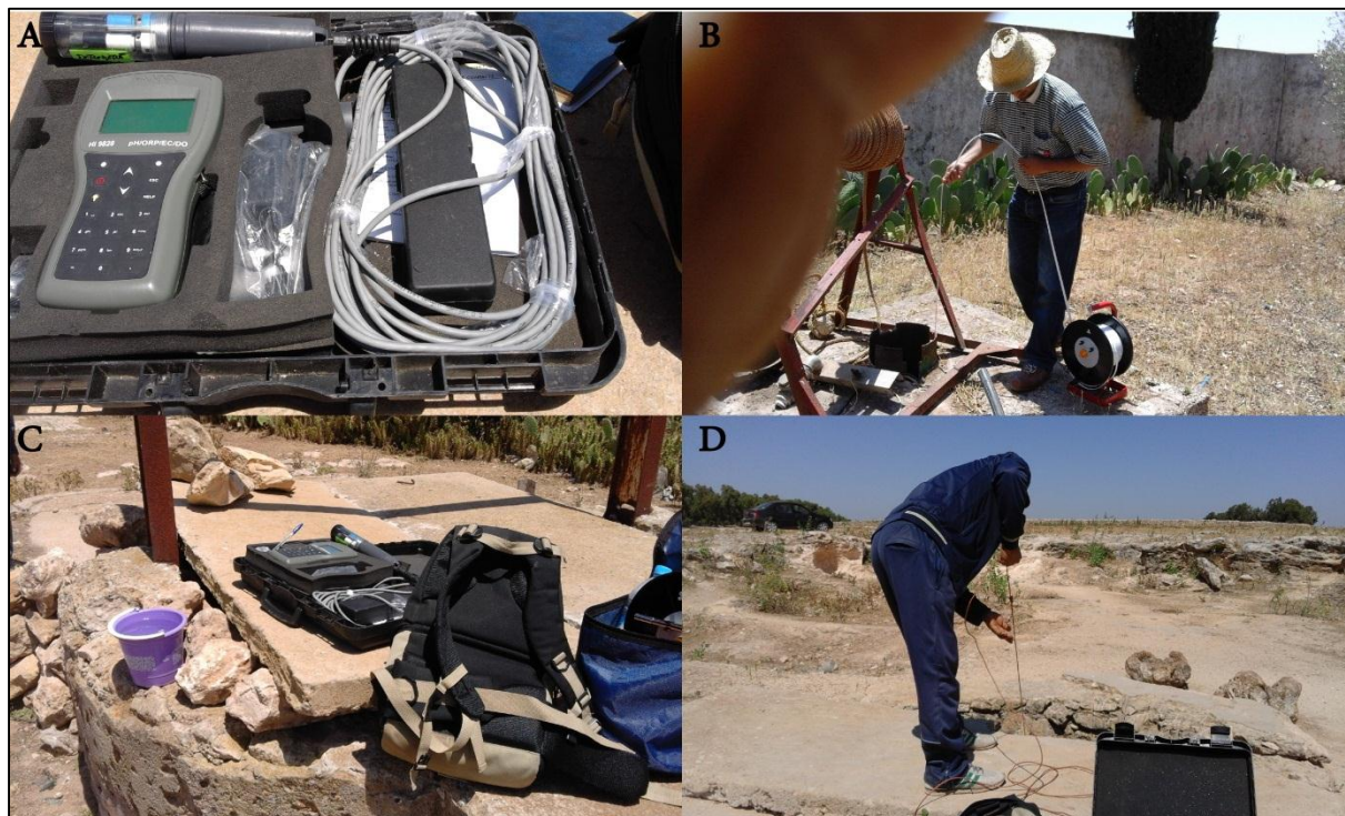
Figure 7.7 - La mesure des paramètres chimiques de l'eau souterraine
