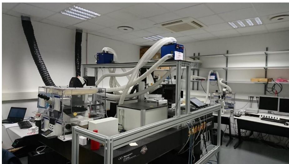
Figure 83. Photo du microscope confocal équipé d'un laser femtoseconde utilisé pour la PDT par excitation biphotonique.
