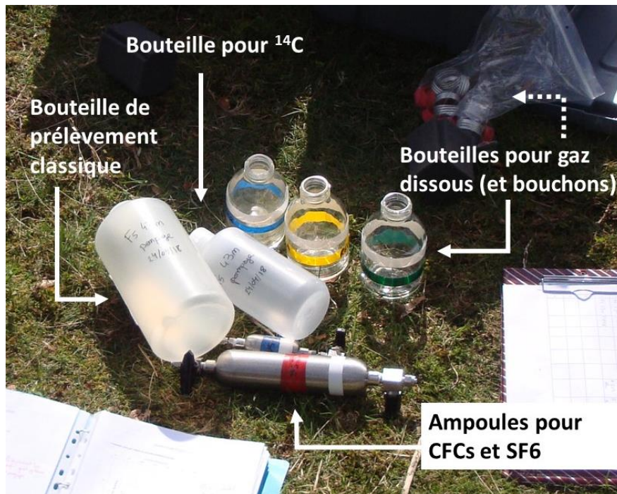
Figure 35: Matériel de prélèvement pour les prélèvements classiques ainsi que pour les CFCs et SF 6 , le 14 C et les gaz dissous (Crédit photo F. Gal)
