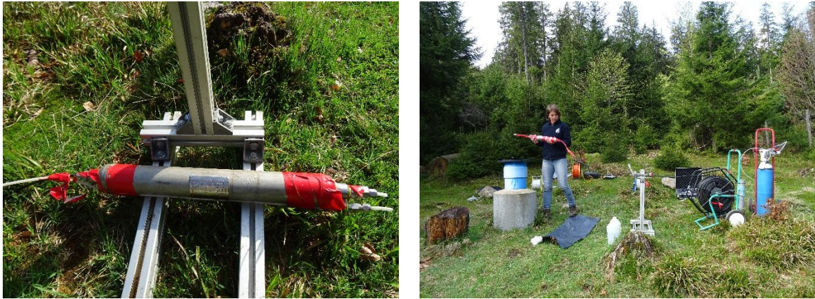
Figure 37: Photos du système de prélèvement de fond avec à gauche le préleveur de fond (bouteille en inox) et à droite l'installation du système avec la bouteille en inox et le système de mise en pression à l'aide d'une bouteille d'azote (crédit J.Ackerer)
