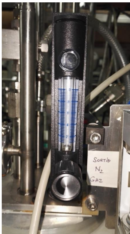
Figure 3.18 – Débitmètre à bille permettant de contrôler le flux de N_2 dans la cellule d'absorption.
