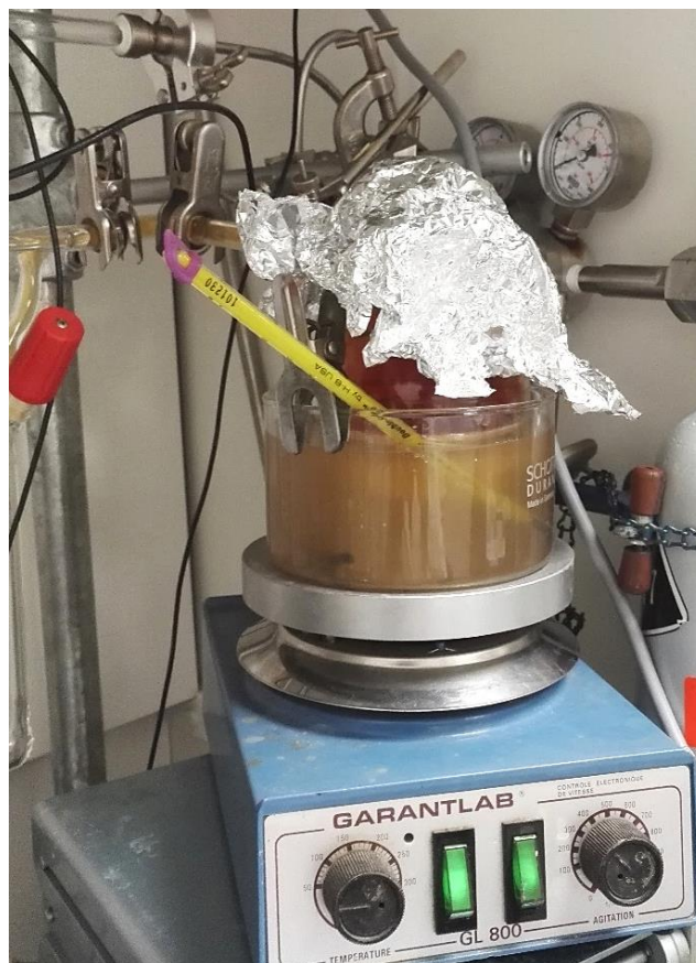
Figure 2.6 – Photo du montage expérimental pour la synthèse de N_2O_5 .
