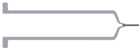
FIGURE 1.3: Schéma d'une seringue vide. Le réservoir cylindrique se termine à une extrémité (à gauche sur l'image) par une collerette, et à l'autre extrémité par une fine aiguille métallique.
