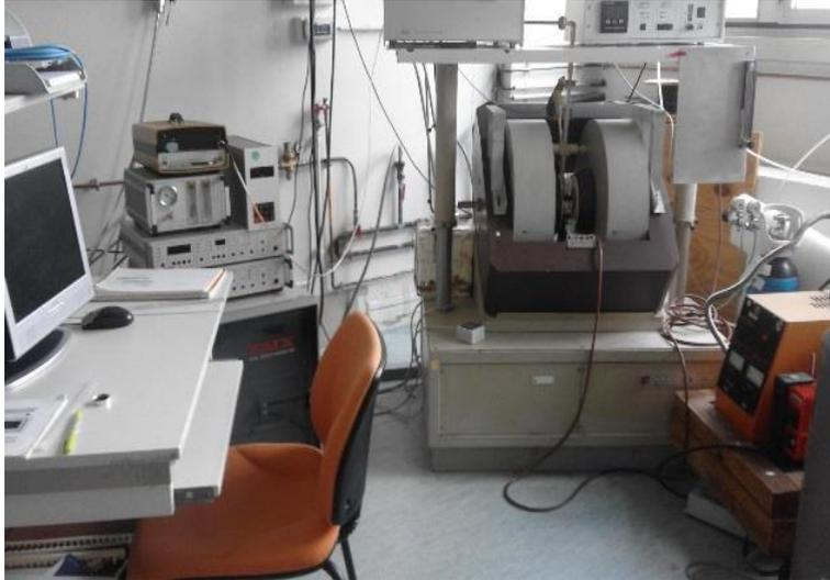
*Figure 7 X-Band EPR spectrometer (LSI)*
