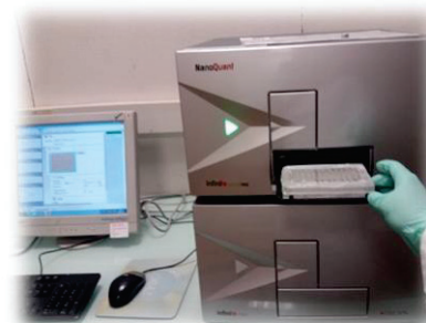
Mesure de la turbidité à 600 nm
