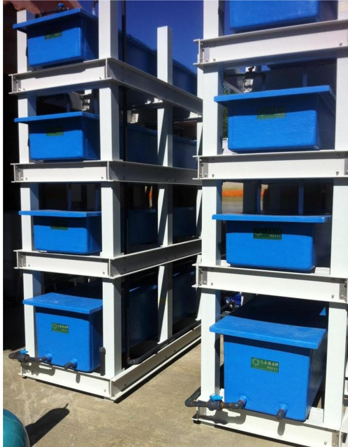
Figure 11 : Système de raceways pour le pré-grossissement des PL (crédit photographique Agostini S., Université de Corse).
