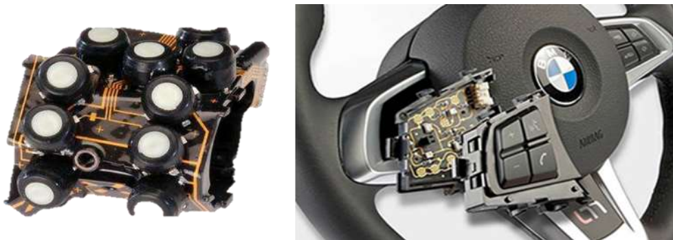
Figure 127: Poignée de moto plastronique et volant BMW
