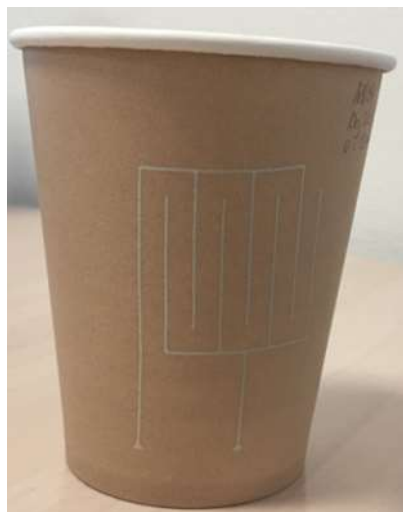
Figure 139 : Circuit imprimé sur un gobelet en carton avec les paramètres d'impression issus du modèle prédictif développé
