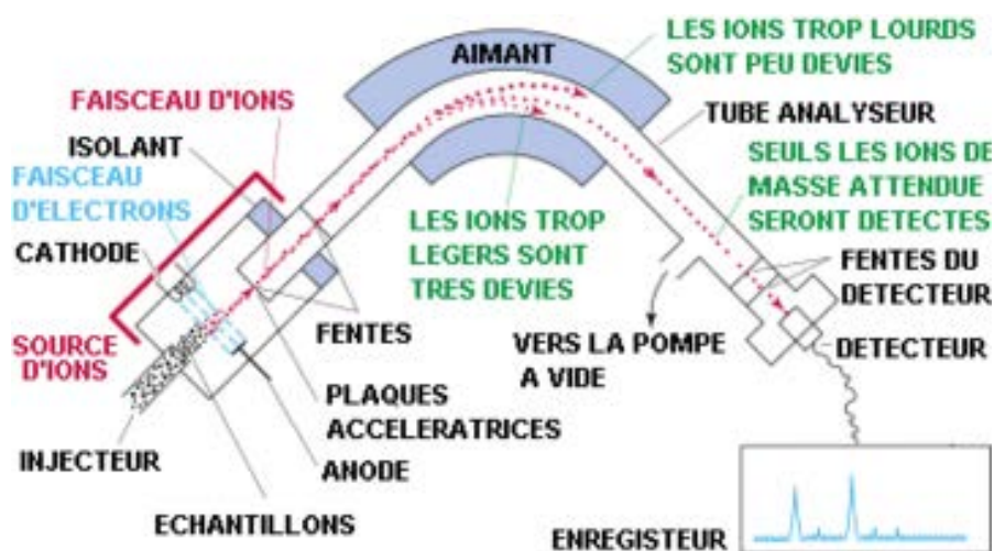
Figure 4 : Schéma de principe de fonctionnement d'un spectromètre de masse [48]
