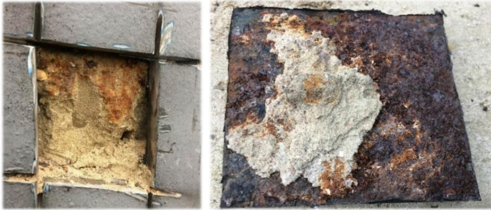
Figure III-15 Photographie d'une zone de prélèvement d'acier en partie aérienne des palplanches et état de surface des prélèvements côté remblai (corrosion superficielle uniforme sur la face en contact avec le remblai)
