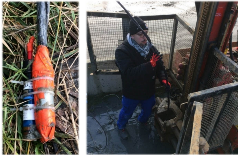
Figure III-12 Électrode de référence \text{Cu} - \text{CuSO}_4 montée sur perche semi-rigide (à gauche) et mesure de potentiel en fond de forage (à droite)
