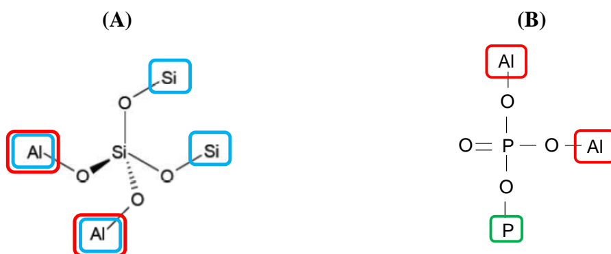
Figure 13 : exemple de notations d'Engelhardt pour les atomes (A) ^{29}\text{Si} - Q^4(2Al) et (B) ^{31}\text{P} .
