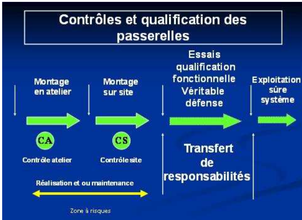
Figure Ann. 33 – Contrôle et qualification des passerelles.
