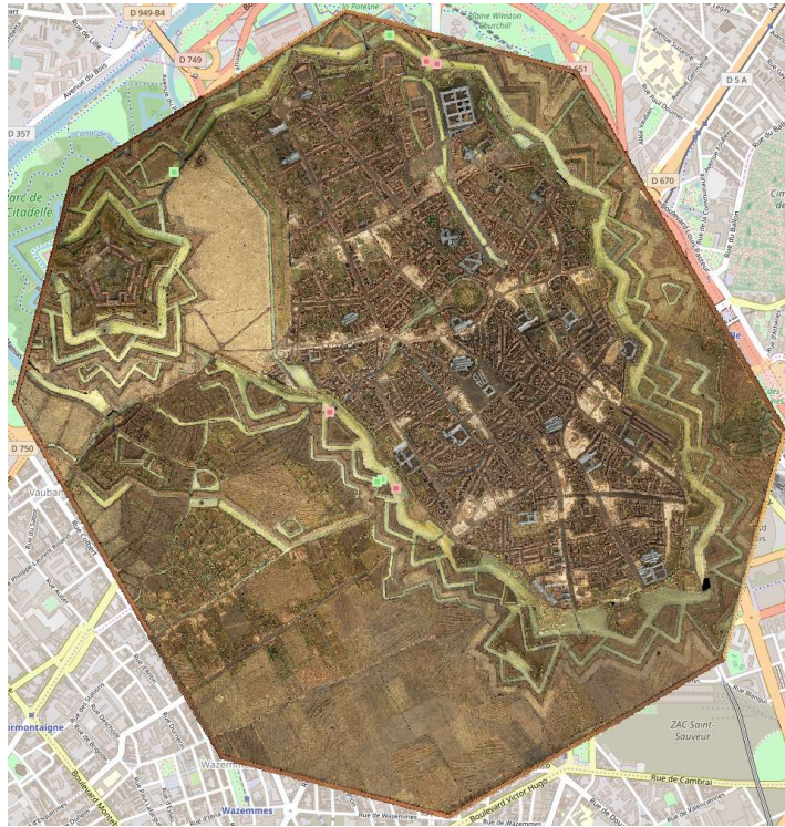
Figure 98 Batardeaux conservés sur le plan-relief (en vert) ou dont les traces sont visibles (en rouge)
