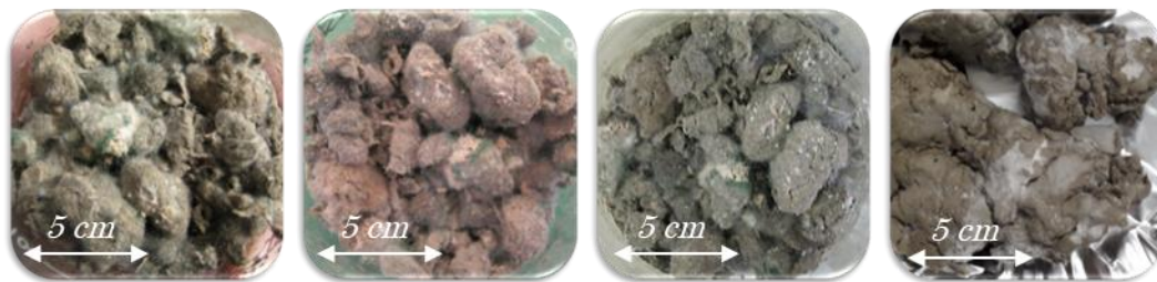
Figure I.15 : Aspects de boues de papier altérées
