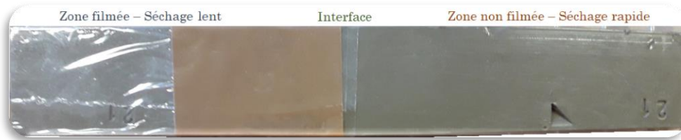
Figure IV.21 : Photographie d'une éprouvette céramique humide préparée pour un séchage différencié
