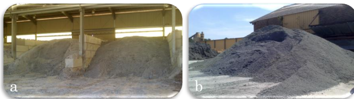
Figure III.7 : Photographies des stocks de boues de papier en box abrité (a) ou en extérieur (b) sur site de production
