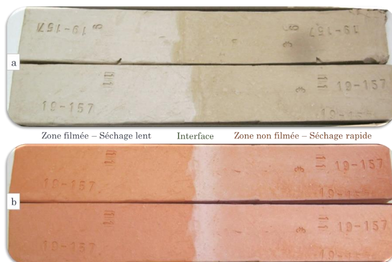
Figure IV.22 : Aspects de surface sec (a) et cuit (b) des éprouvettes de laboratoire ayant subi un séchage différencié
