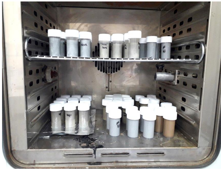
Figure II.7 : Photographie des échantillons de boues de papier placés en étuve pour le vieillissement accéléré des boues de papier en flacons individuels
