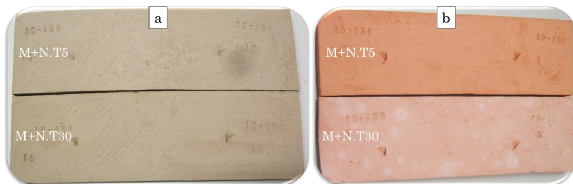
Figure V.6 : Aspects de surface des éprouvettes de laboratoire des mélanges recomposés avec boues de papier stockées à basse ou haute température après séchage (a) et après cuisson (b)
