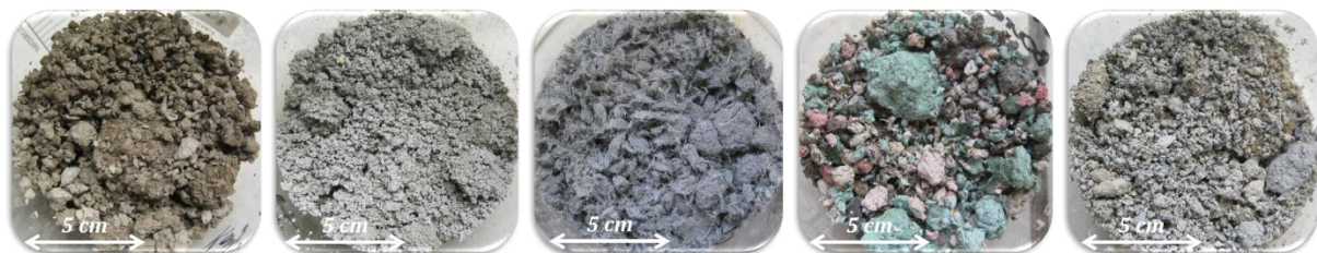
Figure I.9 : Aspects après séchage de boues de papier de diverses origines utilisées sur les sites de production Wienerberger
