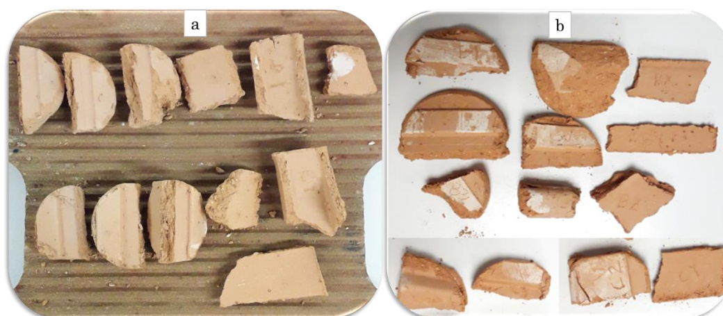
Figure IV.17 : Aspects de surface d'échantillons cuits de sorties filières saines (a) et problématiques (b) prélevés en différents points sur les produits
