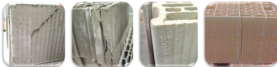
Figure I.13 : Observation de casse et de fissuration sur des produits industriels
