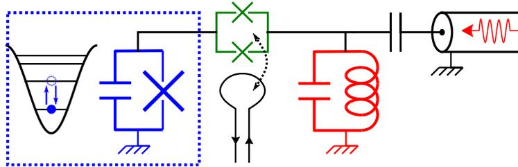
Figure A.2: Exemple de circuit supraconducteur où plusieurs JJ (symbole croix) sont utilisés pour manipuler l'information quantique. Une JJ en parallèle avec une capacité (en bleu) forme un oscillateur anharmonique. Ce qubit peut être sélectivement couplé à un résonateur électrique (en rouge) par l'intermédiaire d'un dispositif supraconducteur appelé SQUID (en vert), dont l'admittance peut être rapidement ajustée en faisant passer un flux magnétique dans la ligne de flux (boucle noire).
