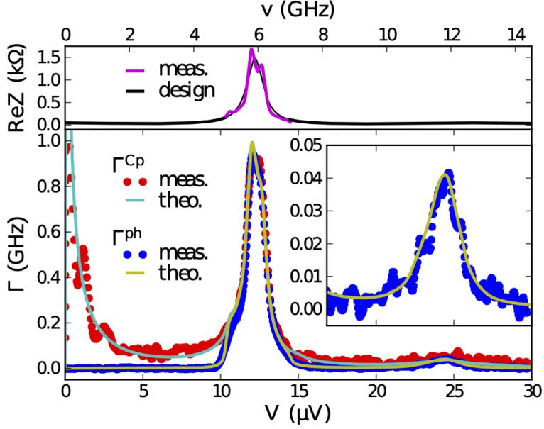
Figure A.6: Résultats de l'expérience décrite dans [33], où ont été mesurés à la fois le taux d'effet tunnel de la paire de Cooper  $\Gamma_{Cp}$  et le taux d'émission de photons  $\Gamma_{ph}$  dans un mode à  $\omega_r/2\pi = 6$  GHz. Sur la résonance à 1 photon,  $2eV = \hbar\omega_r$ ,  $\Gamma_{Cp}$  et  $\Gamma_{ph}$  coïncident. Sur la résonance à 2 photons  $2eV = 2\hbar\omega_r$ , la puissance d'émission à  $\omega_r$  est détectée, indiquant des processus à 2 photons (encadré).
