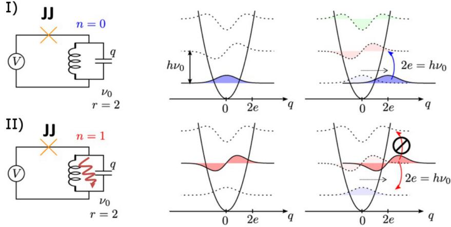
Figure A.8: Mécanisme de blocage des photons dans un mode fortement couplé à un JJ avec  $r = 2$ . Après qu'une seule paire de Cooper a été tunnelisée, le mode se retrouve dans son premier état excité, avec une fonction d'onde déplacée dans l'espace de charge de  $q = 2e$ . Cette fonction d'onde déplacée ne chevauche pas l'état excité suivant, de sorte que la création d'un deuxième photon est interdite.
