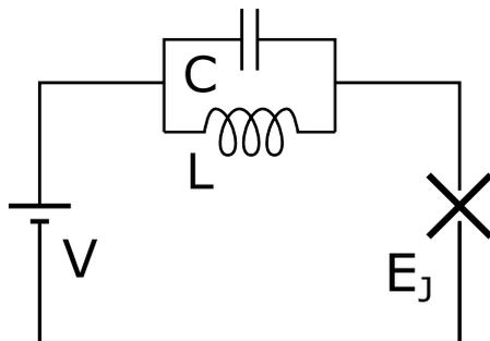
Figure A.7: Un résonateur  $LC$  hébergeant un seul mode du rayonnement est placé en série avec une source de tension continue et une JJ. Les deux dipôles sont couplés : un effet tunnel inélastique à la jonction peut être provoqué par les fluctuations de tension dans le résonateur. En même temps, le courant tunnel à travers la jonction est directement injecté dans l'oscillateur, ce qui crée des excitations dans le mode.
