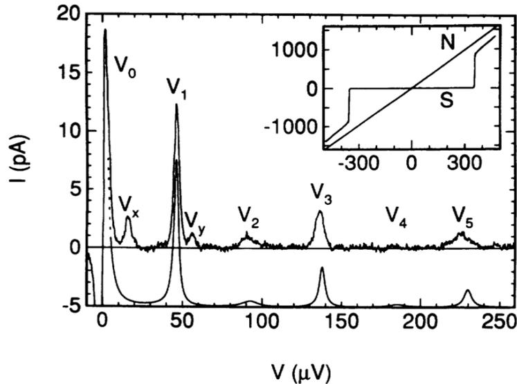
Figure A.5:  $I(V)$  expérimental mesuré en [32]. Un courant continu est mesuré en dessous de la tension de l'écart  $2\Delta/2$ , en raison des processus inélastiques d'effet tunnel des paires de Cooper. Chaque pic à la tension de polarisation  $V_i$  est associée à l'émission de lumière dans une résonance de l'environnement à la fréquence  $2eV_i/\hbar\omega$ , dans des processus où un photon est créé pour chaque paire de Cooper transférée.
