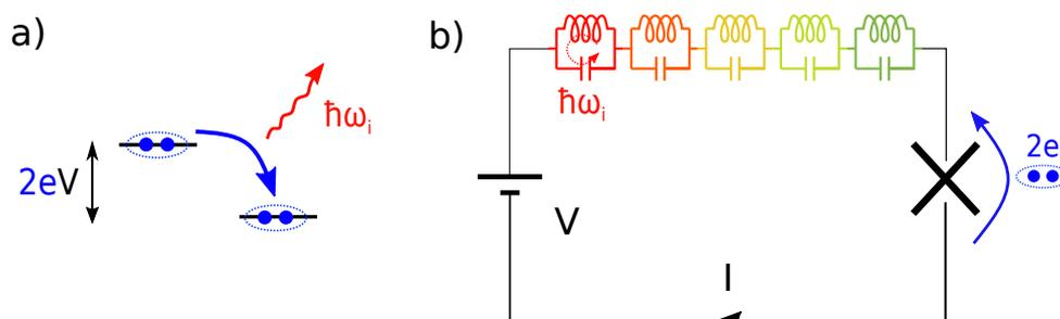
Figure A.4: a) Image schématique d'une paire de Cooper traversant inélastiquement une jonction polarisée en courant continu tout en émettant un photon d'énergie  $\hbar\omega_i = 2eV$ . b) L'énergie pour créer un photon dans un mode de l'environnement (représenté ici comme une collection d'oscillateurs  $LC$ ) est extraite de la source de tension  $V$ .
