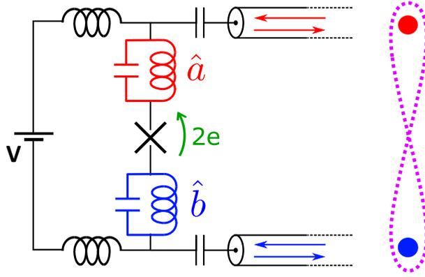
Figure A.11: Deux résonateurs aux fréquences  $\omega_a, \omega_b$  sont connectés à une JJ polarisé en courant continu. Lorsque  $2eV = \hbar\omega_a + \hbar\omega_b$ , des paires de photons intriqués sont créés par effet tunnel des paires de Cooper.
