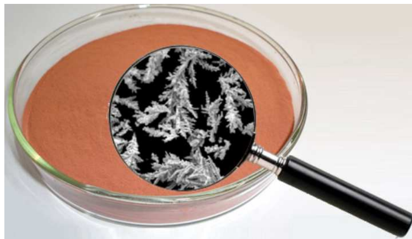
Figure 3-2 : Cuivre dendritique utilisé pour le dépôt de cuivre (66)
