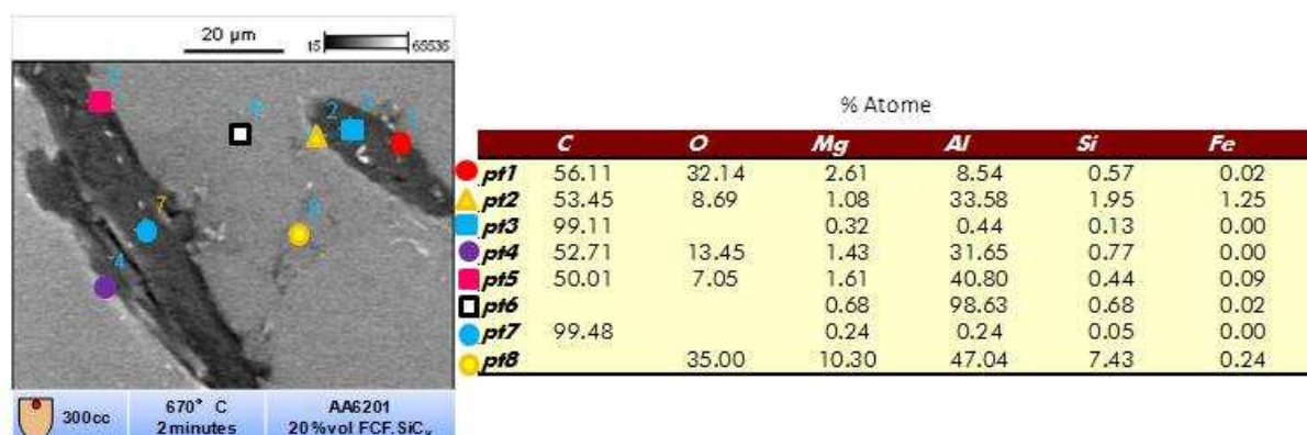
Figure 3-33 : Micrographie et microanalyse sur échantillon élaboré à 670°C
