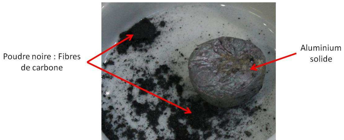
Figure 3-8 : Fibres de carbone non intégrées à l'aluminium
