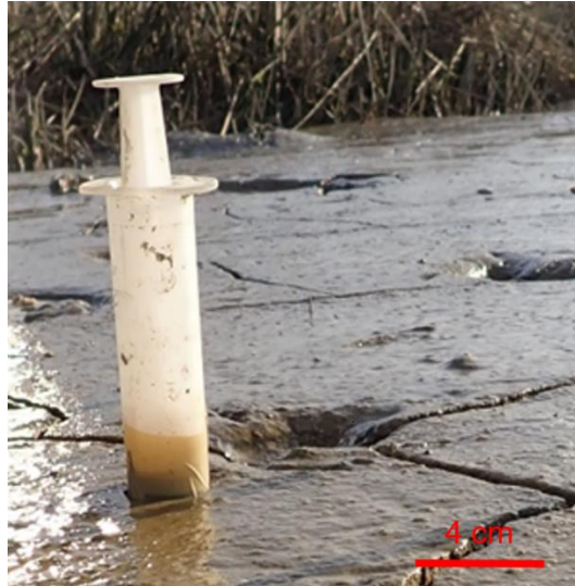
Figure 22 : Seringue découpée utilisée pour le prélèvement de mini-carottes de sédiment (0-1) permettant la quantification de la biomasse chlorophyllienne sédimentaire.
