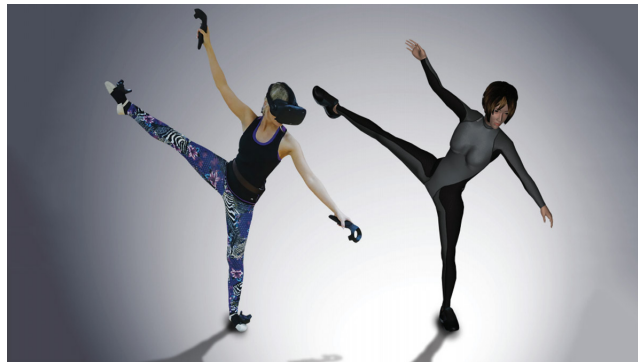
FIGURE 2.17: Capture de mouvement d'une danseuse grâce au Vive Tracker et animation d'un avatar en EV [Source : www.roadtovr.com ]
