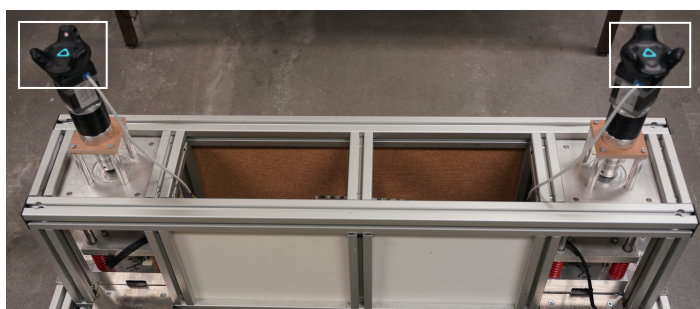
FIGURE 4.13: Emplacements des Vive Tracker (encadrés en blanc) pour le positionnement de la banche virtuelle
