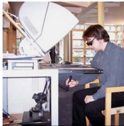
(a) L'interface à retour de force du simulateur
