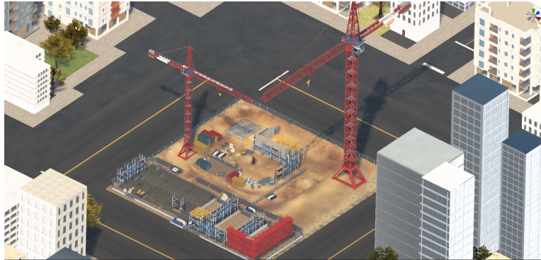
FIGURE 4.9: Représentation 3D d'un chantier extrait d'une maquette BIM
