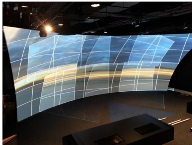
FIGURE 2.38: L'écran hémisphérique de la salle Callisto avec les 8 projecteurs
