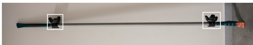
FIGURE 4.14: Suivi de la barre à mine à l'aide des Vive Tracker (encadrés en blanc)
