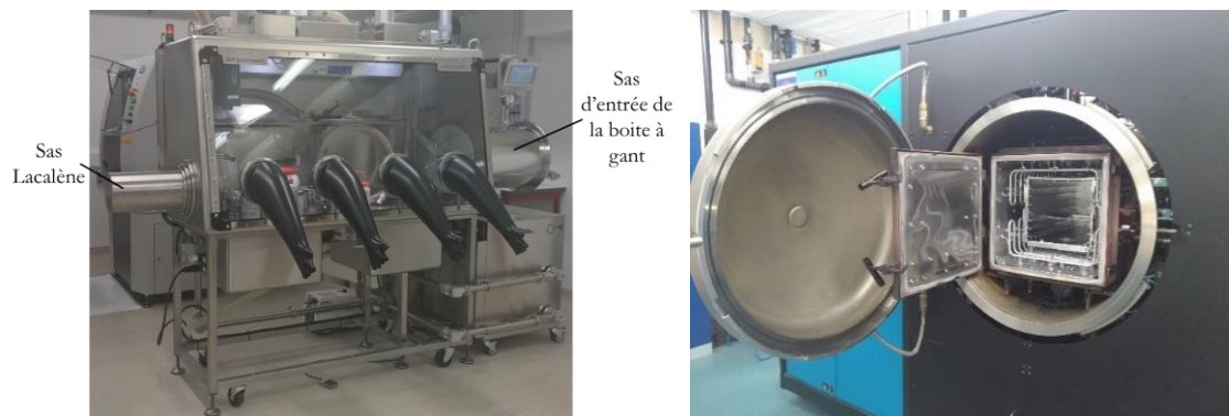
Figure 2.17 : Boîte à gants (a) et four ELNIK (b).
