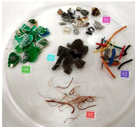
Figure II.4 : Éléments indésirables présents dans le big bag : 1) Pièces métalliques ferreuses, 2) Câbles électriques, 3) Fils de cuivre, 4) Cartes de circuit imprimé et 5) Mousses et élastomères
