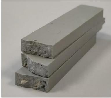
Figure II.19 : Profils de rupture d'éprouvettes de choc
