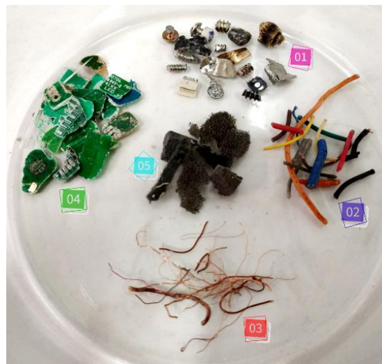
Figure II.4 : Eléments indésirables présents dans le big bag : 1) Pièces métalliques ferreuses, 2) Câbles électriques, 3) Fils de cuivre, 4) Cartes de circuit imprimé et 5) Mousses et élastomères
