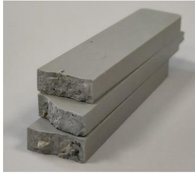
Figure II.19 : Profils de rupture d'éprouvettes de choc
