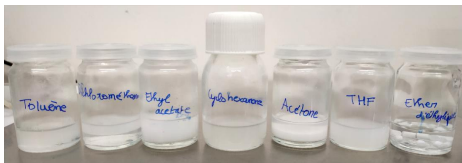
Figure III.9 : Résultats de l'essai de dissolution de granules d'ABS HF380G dans différents solvants
