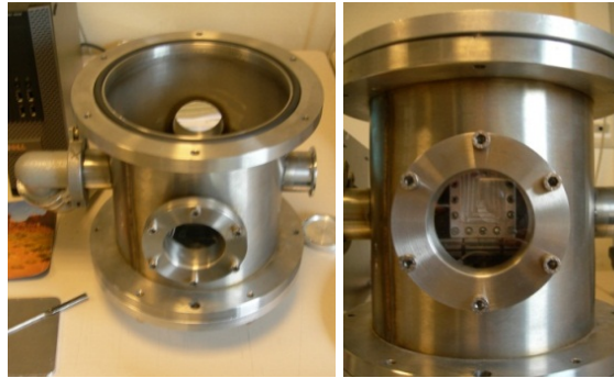
Figure 112 : Photographie du four modèle utilisé pour la première expérience de cuisson en ligne de la tranche de viande par imagerie de neutrons (à gauche). Positionnement de la cellule en aluminium contenant l'échantillon à l'intérieur du four modèle (à droite).
