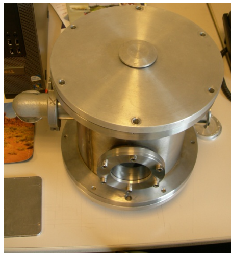
Figure 60 : Photographie du four modèle utilisé pour le premier essai de cuisson en ligne, couplé avec l'imagerie de neutrons.
