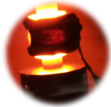
Figure II.5 : Image du moule au cours du frittage à travers la fenêtre à l'avant de l'appareil.
