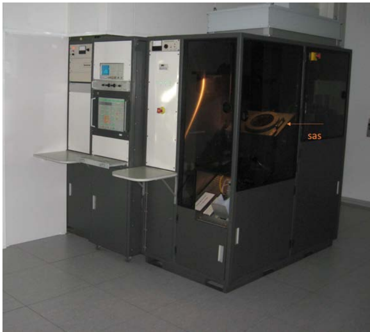
FIG. 3.4 – Photographie de l'implanteur du LAAS à Toulouse. Arrivée du plasma d'implantation par la gauche sur l'échantillon installé dans le sas à droite.
