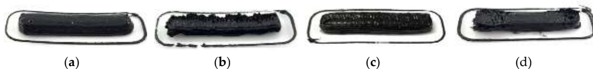
Figure 25 Échantillons imprimés avec une pointe STT sous 4 configurations: (a) sans magnétophorèse; et avec une magnétophorèse consistant en (b) un réseau vertical; (c) réseau horizontal; et (d) matrice de Halbach.
