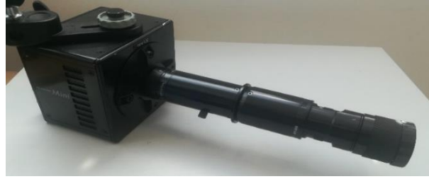
FIGURE 3.4 – Montage expérimental de l’objectif télescopique Navitar sur la caméra Mini UX50.
