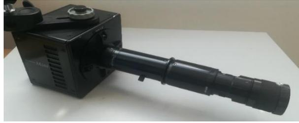
FIGURE 3.4 – Montage expérimental de l'objectif télescopique Navitar sur la caméra Mini UX50.
