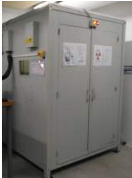
**Figure A.1** – Enceinte de radioprotection de 6 mm d'épaisseur de plomb
