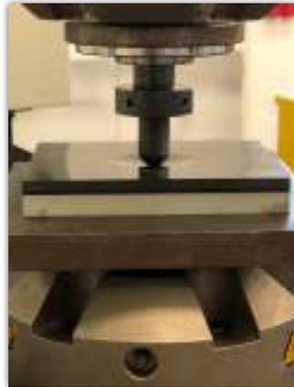
**Figure IV.37** – Déformation locale du 13P 0-90 en cours d’indentation
