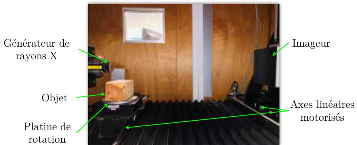
**Figure A.2** – Principaux composants du MICRO-TOMOGAPHE EASYTOM 130
