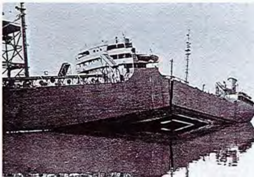
(a) Rupture fragile dans la coque d'un liberty ship durant la deuxième guerre mondiale
