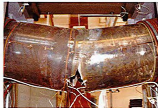
(b) Déchirure ductile en laboratoire d'un tube en acier [Bour 14]
