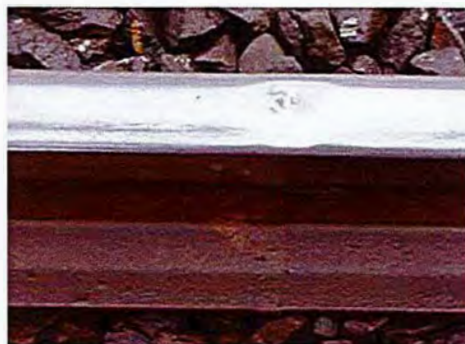
(c) Fissure de fatigue dans un rail SNCF [Trol 14]
