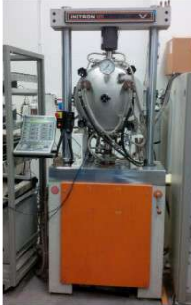
FIGURE 2.11 – Machine hydraulique Instron 1271 utilisée pour les essais de LCF sous vide.
