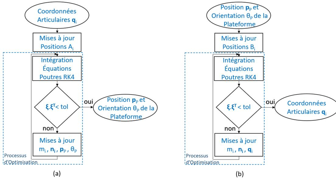
FIGURE II.5 – Logigrammes des méthodes de résolution du système des équations différentielles contraintes par les conditions aux limites (a) le Modèle Géométrique Direct (MGD) et (b) le Modèle Géométrique Inverse (MGI). Dans les deux cas, l’intégration spatiale des équations des poutres se fait en utilisant une méthode de Runge-Kutta d’ordre 4 (RK4).  $\boldsymbol{\xi}$  est le résidu du processus d’optimisation dont le produit doit être inférieur à une valeur de tolérance « tol. »
