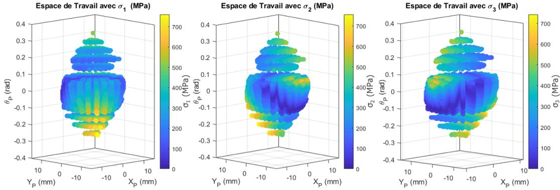
FIGURE II.6 – Espace de travail du 3-PF présentant les contraintes maximales  $\sigma_i$  dans chacun des trois bras. Chaque niveau correspond à l'espace de travail en position pour l'orientation donnée. Les différents niveaux correspondent à l'espace de travail en orientation.
