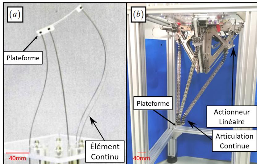
FIGURE I.11 – Prototypage de la plateforme de Stewart-Gough continue [Black 18, Till 17b] et robot Delta utilisant des articulations continues [Yang 18]
