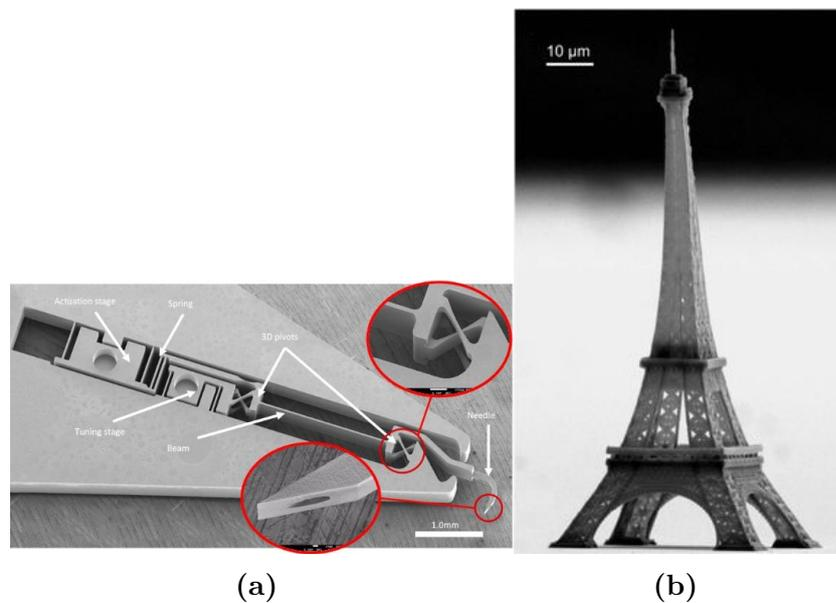
FIGURE V.12 – Réalisations d’une pince pour la chirurgie avec la Femto-Print (a) et d’une tour Eiffel avec la Nanoscribe (b). (images issues de leur site internet respectif)
