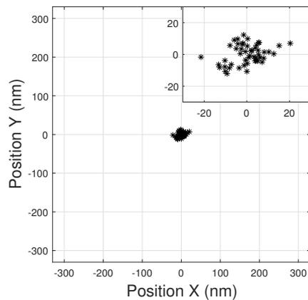
FIGURE IV.6 – Positions et orientations obtenues après avoir mis en place le protocole expérimental proposé. La valeur maximale des distances à la moyenne est de 22 nm et l'écart-type est de 5 nm pour une expérience de 90 s.
