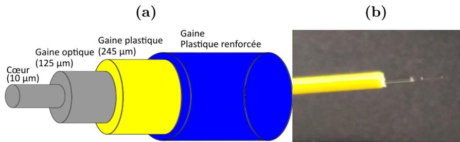
FIGURE III.3 – (a) Schéma de principe montrant les différentes couches d’une fibre optique dont la vue latérale est photographiée en(b).
