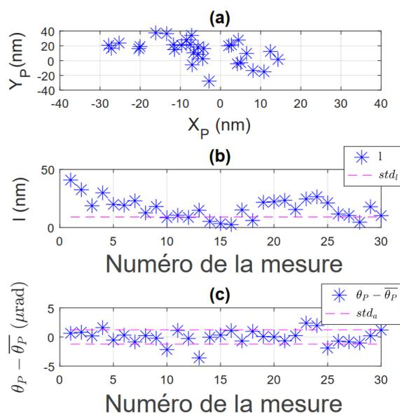
FIGURE IV.9 – Résultats expérimentaux de la quantification de la répétabilité lorsqu’une translation de  $100\ \mu\text{m}$  est effectuée par le premier actionneur  $q_1$  depuis la position  $P_I$ . (a) Positions de la plateforme (b) Distances à la moyenne des positions mesurées de la plateforme. (c) Différences entre les orientations mesurées et leur moyenne. Les écarts-types  $std_l$  et  $std_a$  correspondent respectivement à la répétabilité en position et en orientation.
