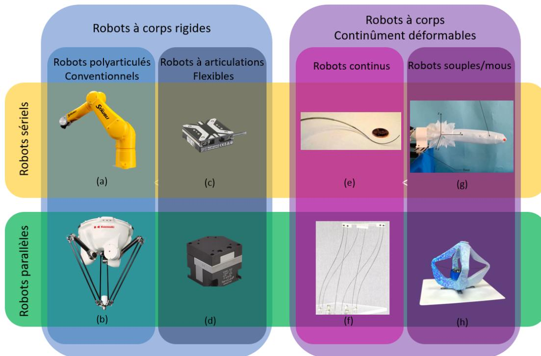
FIGURE I.5 – Proposition de classement des différentes typologies de solutions robotiques. (a) Robot sériel Staübli. (b) Robot parallèle Delta Yamasaki. (c) Platine de positionnement unidirectionnelle et (d) Nanocube de Physik Instrumente. (e) Robot à tubes concentriques [Webster 09]. (f) Robot parallèle continu inspiré de la plateforme de Stewart-Gough [Black 18]. (g) Robot souple sériel gonflable [Kim 18]. (h) Robot parallèle souple actionné par câbles [Duriez 13]
