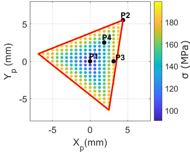
FIGURE III.8 – Espace de travail du Triskèle-Bot avec les différents points de mesure de répétabilité  $P_i, i \in \{1, 2, 3, 4\}$
