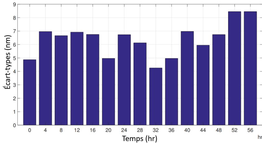
FIGURE IV.7 – Écart-types des distances à la moyenne résultantes des différentes séries d’acquisitions effectuées toutes les 4 heures (hr) pour une durée totale de 56 heures.
