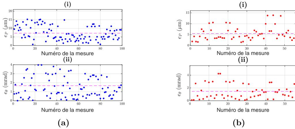
FIGURE V.8 – Erreurs en position (i) et en orientation (ii) pour les ensembles de configurations d’identification et de validation. Les pointillées correspondent aux valeurs moyennes des erreurs, respectivement  $7,19 \mu\text{m}$  et  $1,7 \text{ mrad}$  pour l’identification (a) et  $5,5 \mu\text{m}$  et  $1,5 \text{ mrad}$  pour la validation (b).
