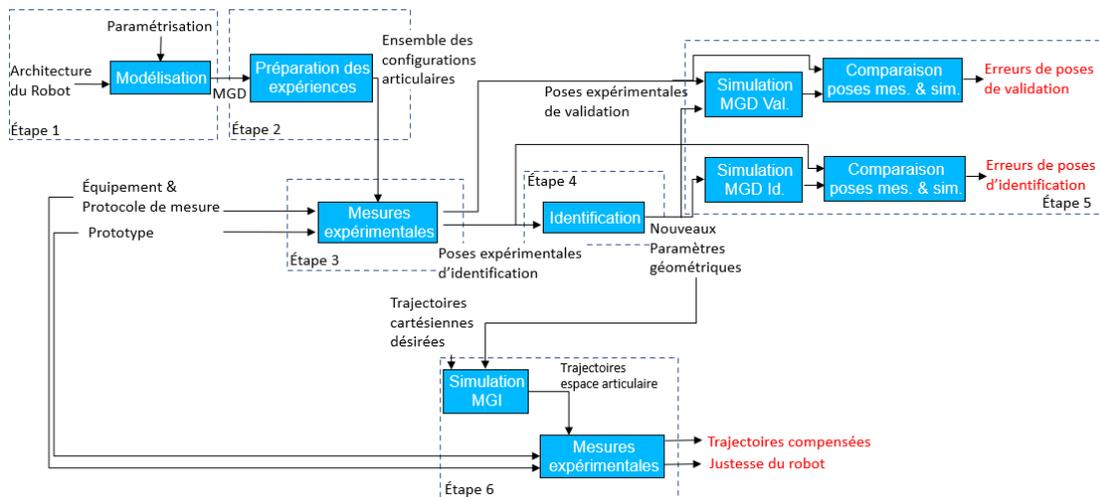
FIGURE V.2 – Processus d'étalonnage complet avec ses différentes étapes.
