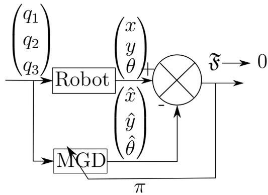
FIGURE V.6 – Principe de l'identification des paramètres. On considère un ensemble de coordonnées articulaires  $\mathbf{q}=(q_1, q_2, q_3)$  pour créer et comparer les poses cartésiennes expérimentales  $(x, y, \theta)$  et calculées par le MGD  $(\hat{x}, \hat{y}, \hat{\theta})$ . Les paramètres  $\boldsymbol{\pi}$  de ce dernier sont changés itérativement pour réduire les valeurs du vecteur résidu  $\tilde{\mathfrak{F}}$ .
