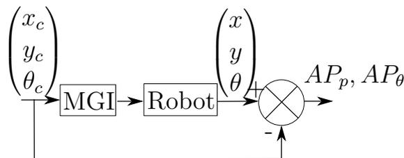
FIGURE V.9 – Principe de la commande en position et de la quantification de la justesse en position  $AP_p$  et en orientation  $AP_\theta$  du Triskèle-Bot.
