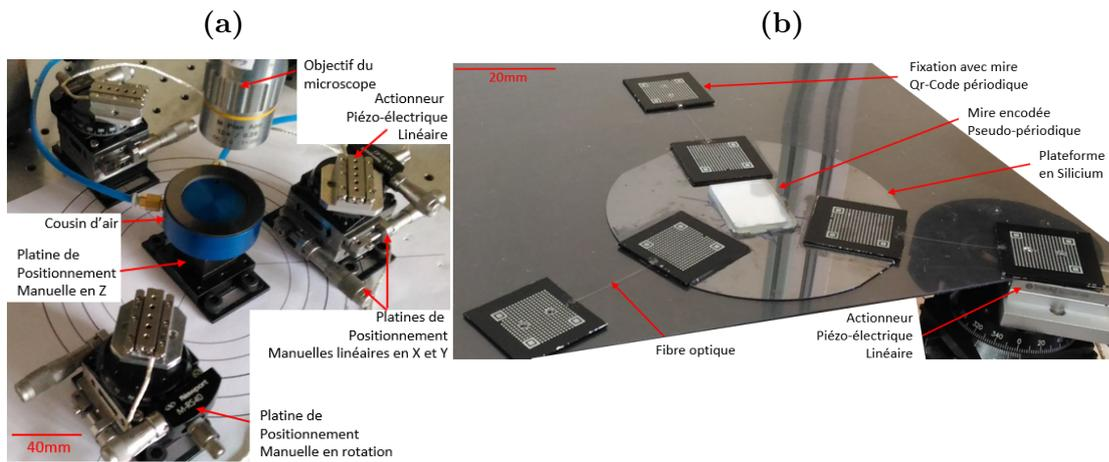
FIGURE III.2 – Composants avant assemblage : (a) Coussin d’air, actionneurs et les platines de prépositionnement. (b) Plateforme.
