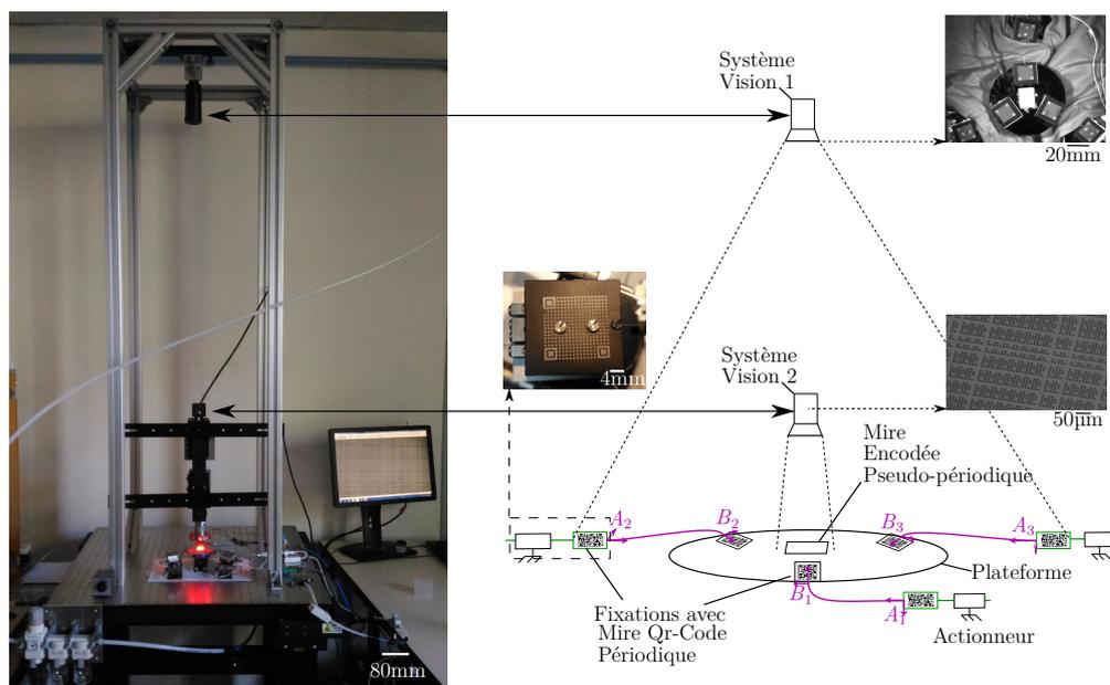
FIGURE III.5 – Systèmes de mesure par vision utilisés dans cette thèse.
