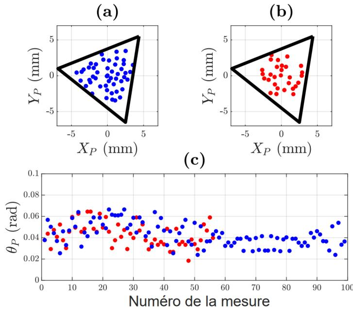
FIGURE V.4 – Positions (a,b) et orientations (c) de la plateforme considérant les ensembles de configurations articulaires destinés aux étapes d’identification (bleu) et de validation (rouge).
