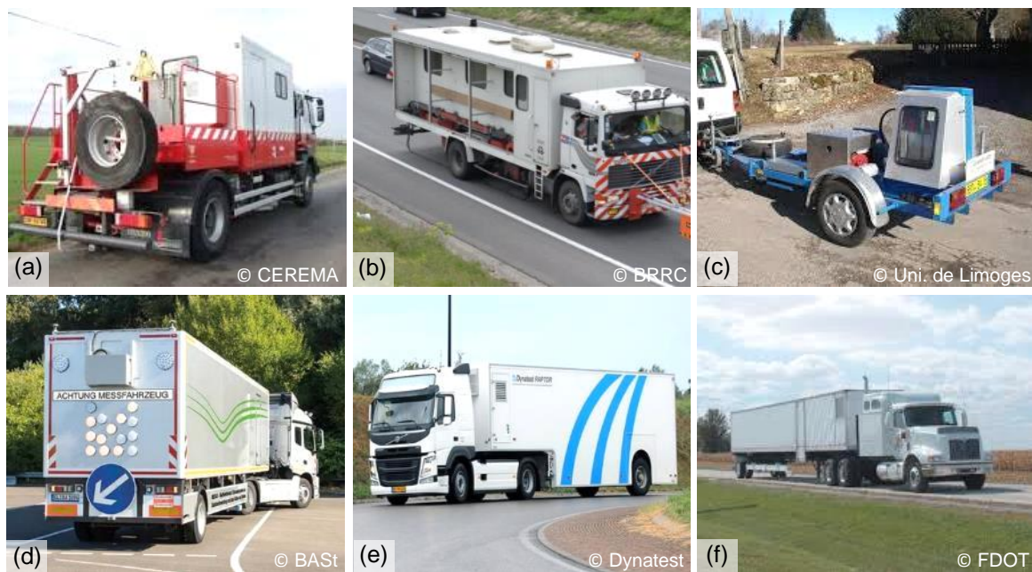
Figure 1.39 – Principaux appareils de mesure de déflexion : (a) Déflectographe ; (b) Curviamètre ; (c) Falling Weight Deflectometer ; (d) Traffic Speed Deflectometer ; (e) Rapid Pavement Tester ; (f) Rolling Weight Deflectometer
