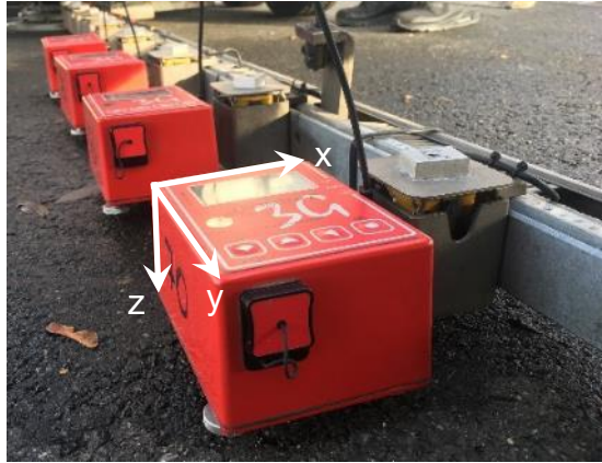
Figure 2.26 – Capteurs 3D Tromino® posés à côté des géophones du HWD (photographie JM Roussel)
