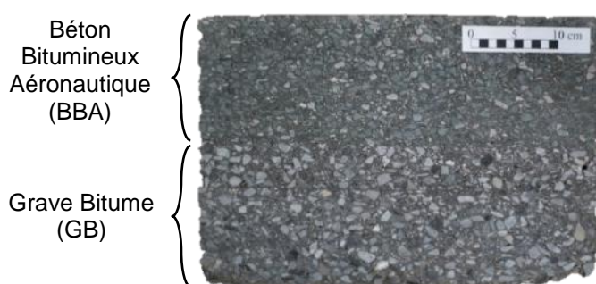
Figure 2.40 – Vue de profil du bloc extrait
