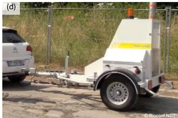
Figure 1.48 – Quelques modèles de déflectomètres à masse tombante : (a) HWD Carl Bro PRI3000 (STAC) ; (b) FWD KUAB 50 (Colas Hongrie) ; (c) HWD Dynatest 8082 (STAC) ; (d) HFWD Rincint Heavydyn (Rincint NDT)
