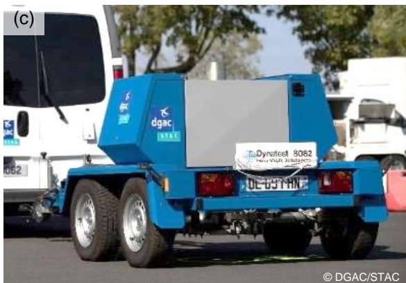
Figure 1.48 – Quelques modèles de déflectomètres à masse tombante : (a) HWD Carl Bro PRI3000 (STAC) ; (b) FWD KUAB 50 (Colas Hongrie) ; (c) HWD Dynatest 8082 (STAC) ; (d) HFWD Rincint Heavydyn (Rincint NDT)
