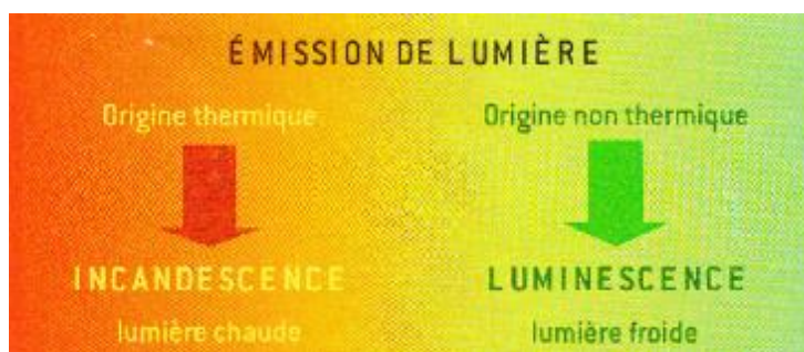
Figure 1 : Principes d'incandescence et de luminescence 3
