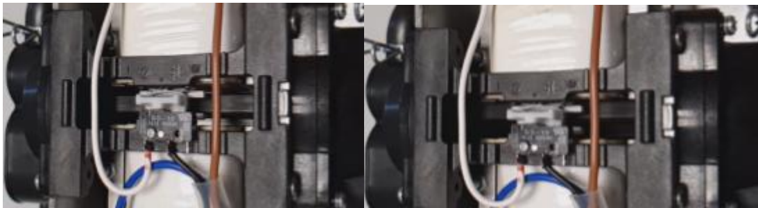
Figure 19 : (à gauche) position normale du kit aimant. (À droite) Contact du kit aimant avec le bord de l'électro-aimant.
