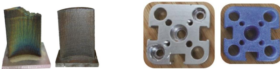
Figure 12 : (A gauche) Remanufacturing d'une aube de turbine par DED. (À droite) Remplacement d'une plaque de joug par DFF.
