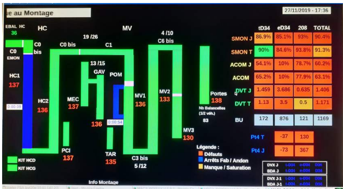
Figure 17: Tableau synoptique du flux de production du montage des véhicules - 2019
