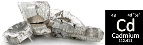
Figure 7 : Cristal de Cd et place du Cd dans la classification périodique des éléments. Numéro atomique 48, masse atomique : 112,414± 0,004 g/mol, configuration électronique : 4d 10 5s 2 .
