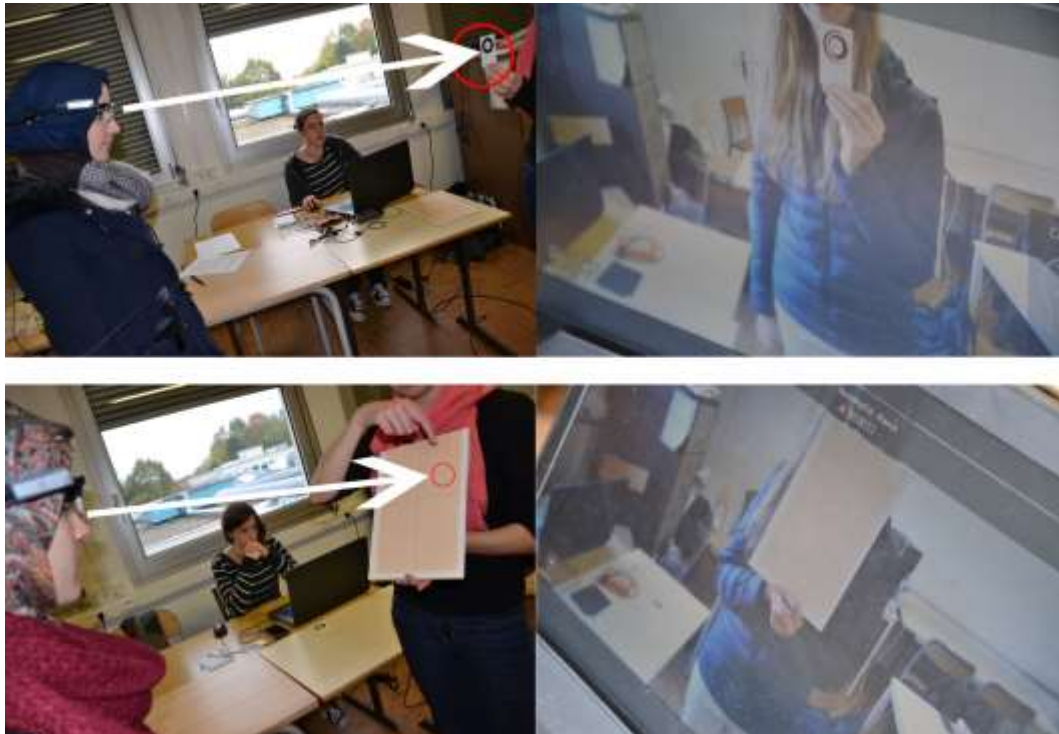
Figure 93 : Calibration, phase 1. A gauche, photos de l'activité. A droite, ce que l'on voit sur l'écran du système eye-tracking
