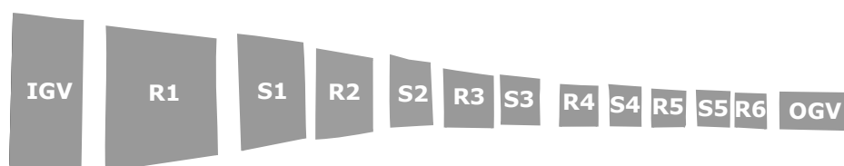
Figure 2.20 – Vue schématique méridienne des pales du compresseur haute pression étudié
