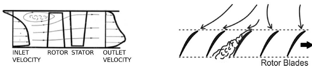
(a) Développement radial selon la vue méridienne [49] (b) Propagation azimuthale selon la vue aube à aube [46]
