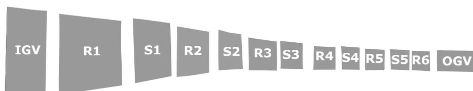
Figure 2.20 – Vue schématique méridienne des pales du compresseur haute pression étudié
