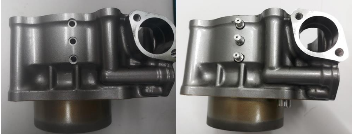
Figure 22 : Vue de côté des perçages pour l'installation des thermocouples de chemise. A gauche après perçage, à droite après insertion des fourreaux.
