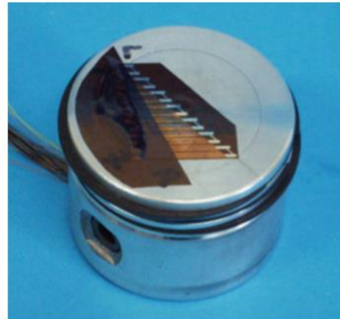
Figure 85 : Schéma du dispositif de mesure à film fin utilisé par Wilson et al. [96] et photographie du piston instrumenté.
