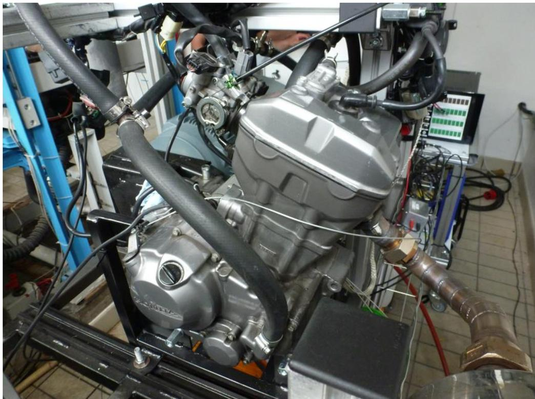
**Figure 19 : Le moteur CRF250 au banc d'essais**
