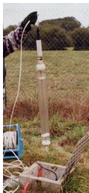
Photo 2 : système de pompage Grunfoss. Photo 3 : préleveur mécanique (ISMA, Forbach)
