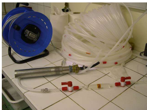
Photo 2 : système de pompage Grunfoss. Photo 3 : préleveur mécanique (ISMA, Forbach)
