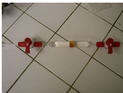
10 11 Photo n°4 et n°5 : ampoules de prélèvement en verre de 30 mL, en cours de remplissage.
