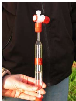
10 11 Photo n°4 et n°5 : ampoules de prélèvement en verre de 30 mL, en cours de remplissage.
