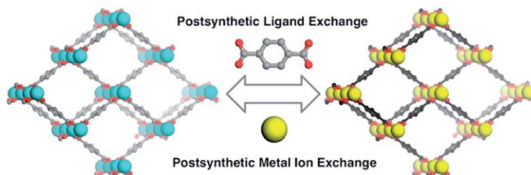
Figure 19 : principe du procédé de modification post-synthèse par échange de ligand et par échange d'ions métalliques au sein d'un réseau préformé. D'après référence 91.
