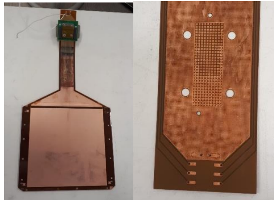
Figure 4-1 Photo d'un détecteur Micromegas Microbulk pour PandaX-III de version 1 (gauche) et un zoom sur son connecteur (droite) au bout de la limande de connexion. La surface active du détecteur est de 20 \times 20 \text{ cm}^2 .
