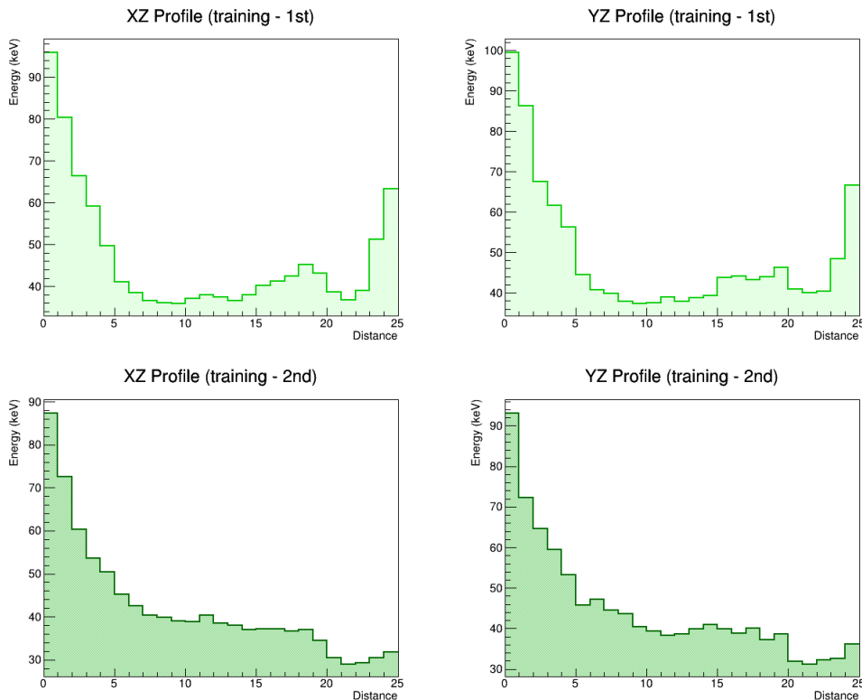
Figure 5-24 : Répartitions moyennes de l'énergie le long des traces pour les projections XZ et YZ d'une population d'événements double bêta sans émission de neutrino (haut) et de gamma provenant du support de cuivre et du plan de Micromegas (bas).
