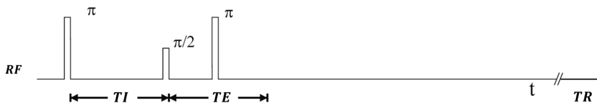
Figure I.3-4 Chronogramme RF de l'application d'une inversion récupération sur une séquence en écho de spin [3].
